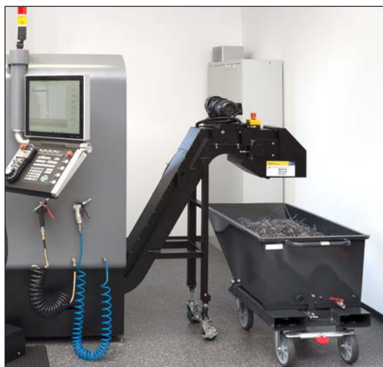
Anwendungsbeispiel: Muldenkipper als Spänebehälter
