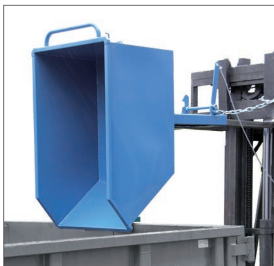
Kippbehälter als Abfallbehälter mit Gabelstapler
